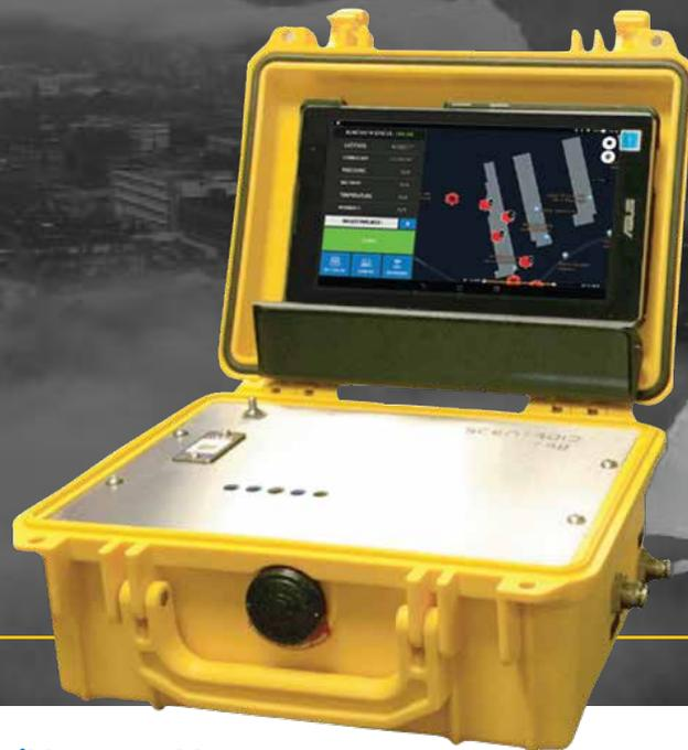
El Scentroid TR8 Plus Pollutracker es un completo monitor portátil de calidad del aire y laboratorio móvil. Los usuarios pueden medir simultáneamente hasta 10 calidad del aire ambiente y gases de efecto invernadero utilizando hasta una combinación de 10 tipos de sensores diferentes, como: electroquímicos (EC), detectores de fotoionización (PID), infrarrojos no dispersivos (NDIR), radiación y ruido. sensores y muchos más.
