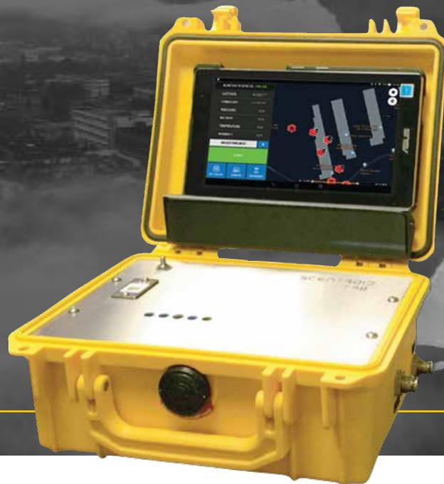
El Scentroid TR8 Odotracker es un completo monitor portátil de calidad del aire y laboratorio móvil. Los usuarios pueden medir simultáneamente hasta 2 calidad del aire ambiente y gases de efecto invernadero utilizando hasta una combinación de 2 tipos de sensores diferentes, como: electroquímicos (EC), detectores de fotoionización (PID), infrarrojos no dispersivos (NDIR), radiación y ruido. sensores y muchos más.
